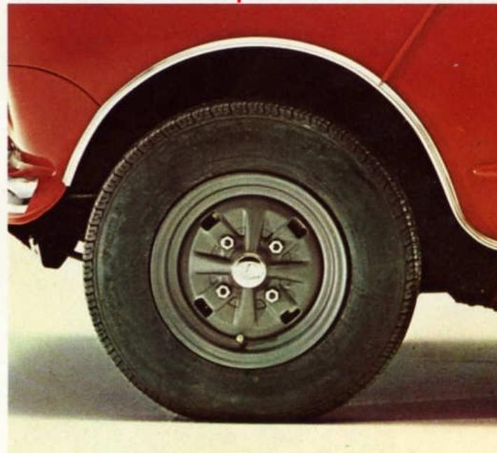
I cerchi «alta velocità» sono di nuovo disegno. Pneumatici a carcassa radiale 145 x 10".
