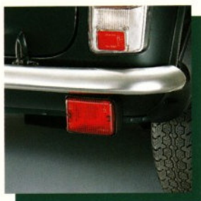
濃霧時の追突防止にも対処。リア・フォグ・ランプ。
