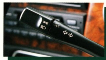
スマール/ヘッドランプの切り替えスイッチはレバー式とし、ステアリングコラム左側に。操作性が大きく向上。
